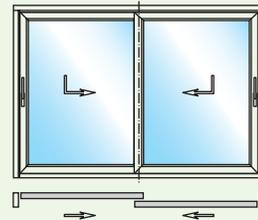
Ob großzügiger Durchgang durch die Mitte oder wahlweise durch die äußeren Schiebeflügel – dem Zugang in den Außenbereich sind keine Grenzen gesetzt.
